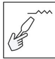
7. Avec l'extrémité de la spatule appliquez la masse préparée sur la zone engommagée.
