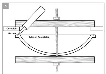
Fixez les planches pour que l'évier reste suspendu à environ 1 pouce sous le comptoir. Nettoyez le rebord de l'évier et le dessous de la zone découpée du comptoir, en vous assurant que la zone est lisse et exempte de débris. Appliquez uniformément un cordon de calfeutrage en silicone sur le dessus de la bride de l'évier.
