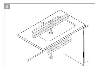
Fixez l'évier et maintenez-le en place pendant que l'adhésif durcit. Il existe différentes méthodes, nous suggérons d'utiliser quelques morceaux de bois avec une tige filetée. Placez un morceau de bois sous l'évier et un autre sur le comptoir.
