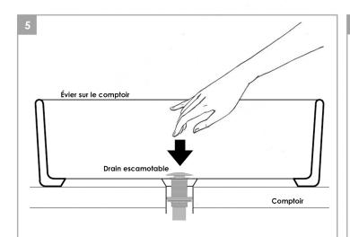
Positionnez l'évier sur le comptoir, alignez le trou de drainage avec le trou du comptoir et installez un drain escamotable qui servira également d'ancre pour maintenir l'évier en place.
