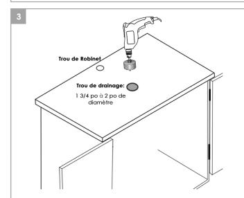
Percez un trou de drainage sur le comptoir, la taille recommandée du trou de drainage est de 1 -3/4 pouces à 2 pouces.
