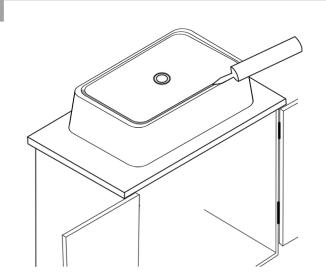
Lorsque l'évier est prêt à être installé, placez-le à l'envers et appliquez un trait de silicone sur le canal extérieur de l'évier, ou utilisez un cordon de mastic de plombier.
