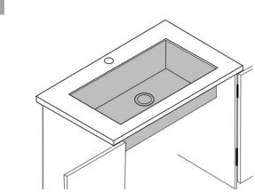
Vérifiez à nouveau l'alignement de l'évier et resserrez les attaches pour sécuriser l'évier. Essuyez l'excès de mastic silicone avec un chiffon humide. Raccordez l'évacuation et l'alimentation en eau conformément aux instructions du fabricant.
