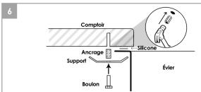
**Option 1.** Insérez des ancrages sous le comptoir sur les trous percés, afin qu'ils soient prêts à fixer la bordure de l'évier. Les ancrages doivent être insérés à l'aide d'un marteau jusqu'à ce que la surface soit lisse.
