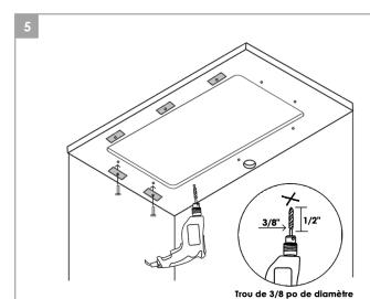
Percez des trous sur la face inférieure du comptoir, à environ 1/2 po. du bord de l'évier à installer. Les trous doivent être régulièrement espacés d'environ 6 à 8 pouces à partir de chaque coin, comme indiqué ci-dessous.
