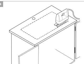
Tracez le contour du gabarit et découpez le comptoir selon le contour du gabarit en utilisant les outils de coupe appropriés. Le modèle est donné à titre indicatif seulement. Utilisez un évier pour assurer une ouverture précise de la découpe. Il est recommandé d'utiliser les dimensions réelles de l'évier pour assurer la découpe la plus précise possible. Le dessin ou le gabarit sert de référence.
