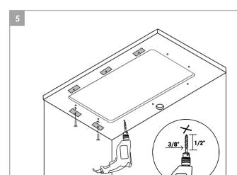
Trou de 3/8 po de diamètre par 1/2 po de profondeur
